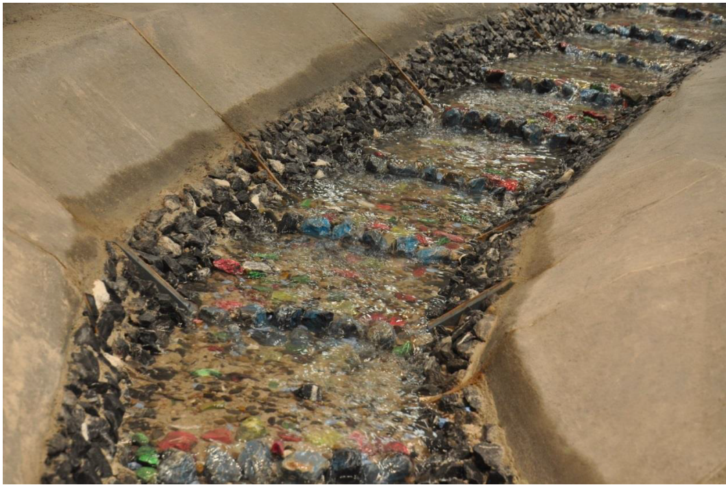
Abbildung 22: Modellversuch bei Niederwasser (nach Durchgang eines Extremhochwassers). Versuch A2_03.1_HQ300G. Foto: HSR.
