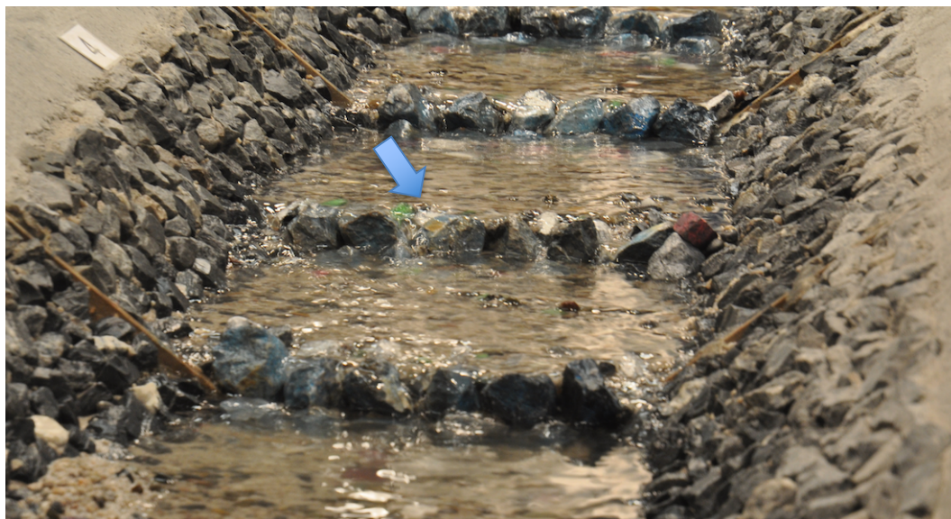
Abbildung 27: Niederwasserrinne zwischen zwei Blöcken in einem Querriegel (Foto: Modellversuche HSR, 1.4 m 3 /s Abfluss).
