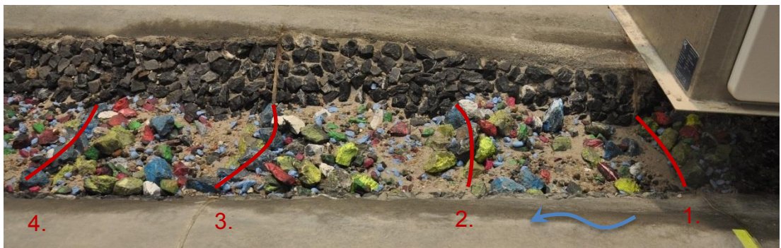
Abbildung 61: Zerörte Stufen Nr. 1 bis 3 nach 123.3 \text{ m}^3/\text{s} .
