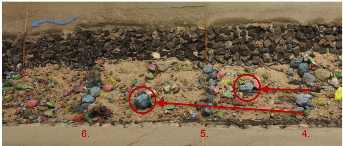
Abbildung 74: Beschädigte Stufe Nr. 4 nach 1. Versuch mit HQ_{100} Ganglinie.
