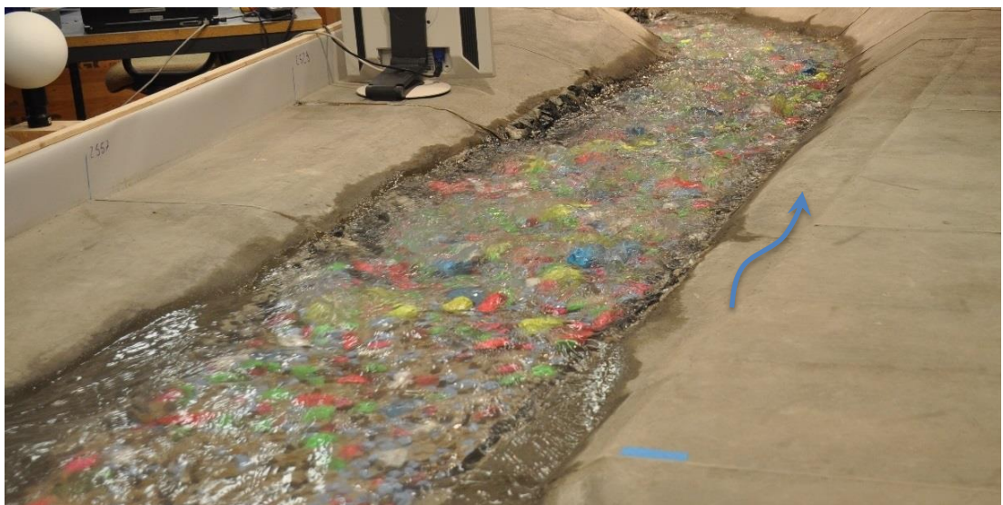
Abbildung 13: Wellenbildung bei HQ_{30} . Einzelne Stufen-Becke-Sequenzen sind erkennbar.
