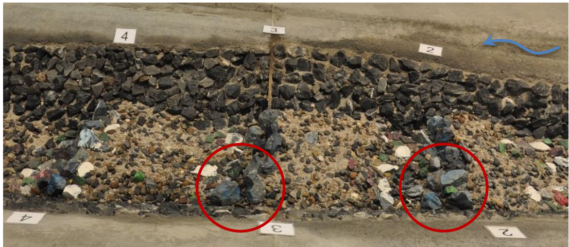
Abbildung 85: Stufen Nr. 2 bis 4 nach HQ_{300} -Überlastfall.
