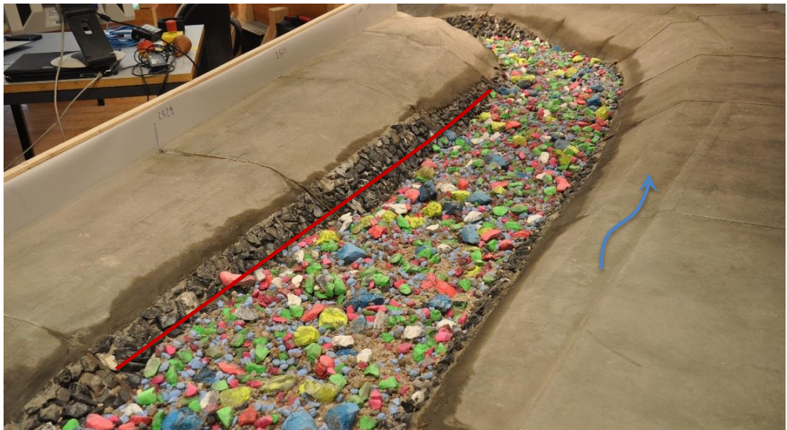
Abbildung 12: Oberer Bereich des Projektperimeters nach einem HQ_{30} . Die rote Linie zeigt die Ausgangssohlenlage.
