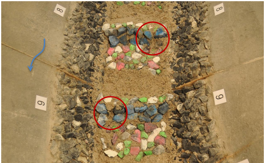
Abbildung 88: Stufen 8 und 9 mit Kolkenschutz mit rot markierten Aufstiegs-lücken.
