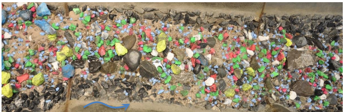
Abbildung 17: Geschiebeausstrag am Ende des Projektperimeters nach HQ 5 bei Versuch A1_01.1.
