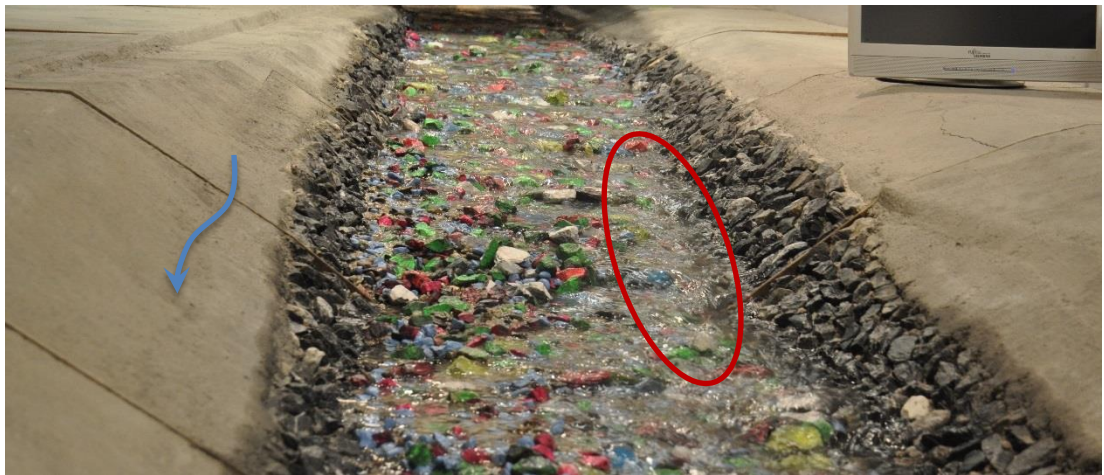
Abbildung 35: Gerinne bei Niederwasser nach 5.8 h HQ 5 , mit rot markierter Rinnenbildung.
