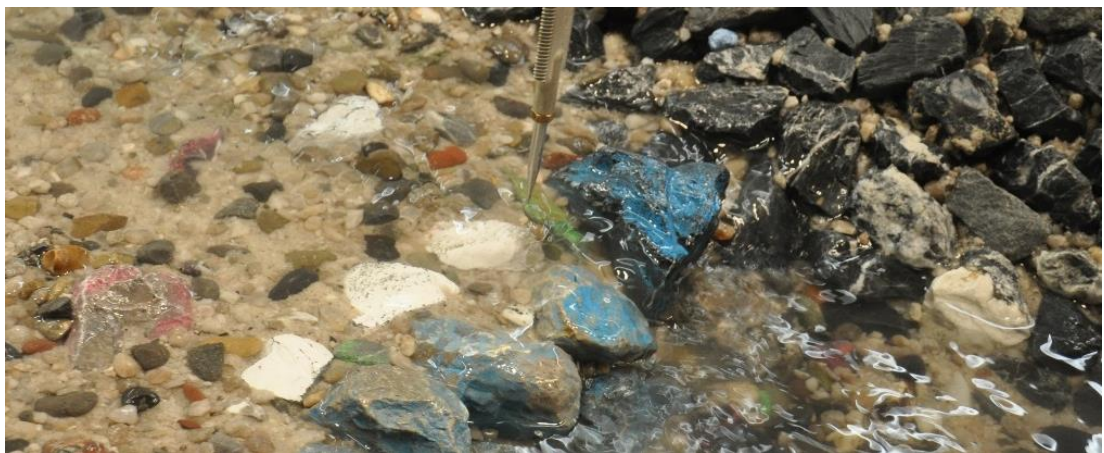
Abbildung 97: Wasserspiegelmessung bei Stufe 8 mit Stechpegel bei 1.4 m 3 /s.
