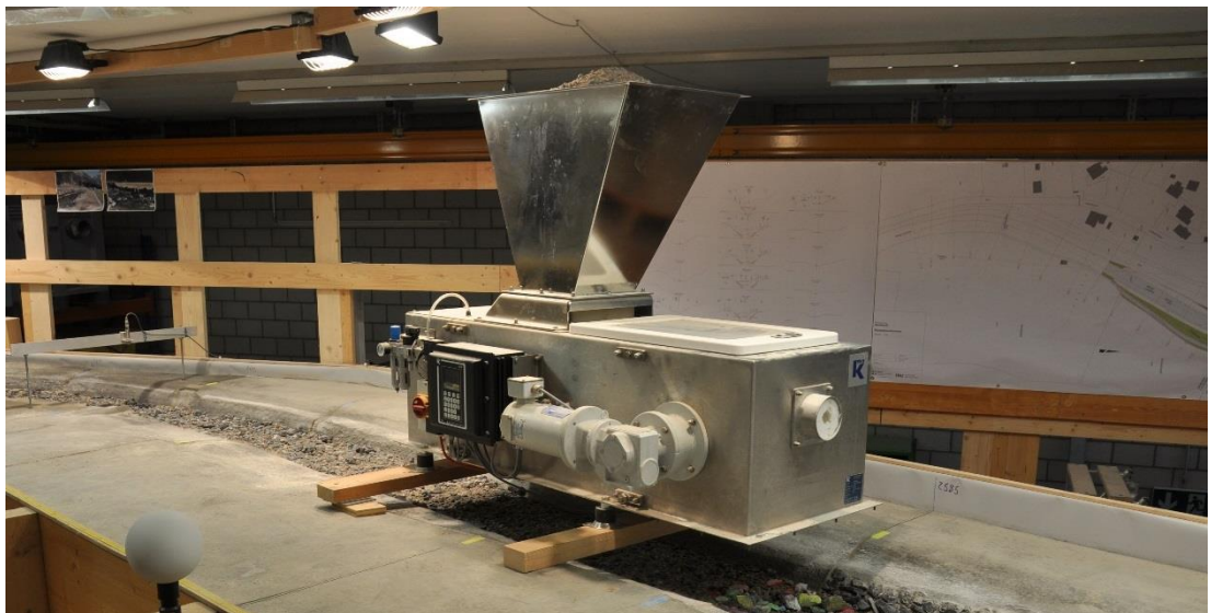
Abbildung 9: Bandwaage von K-Tron mit einer Leistung bis zu 45 kg/min.
