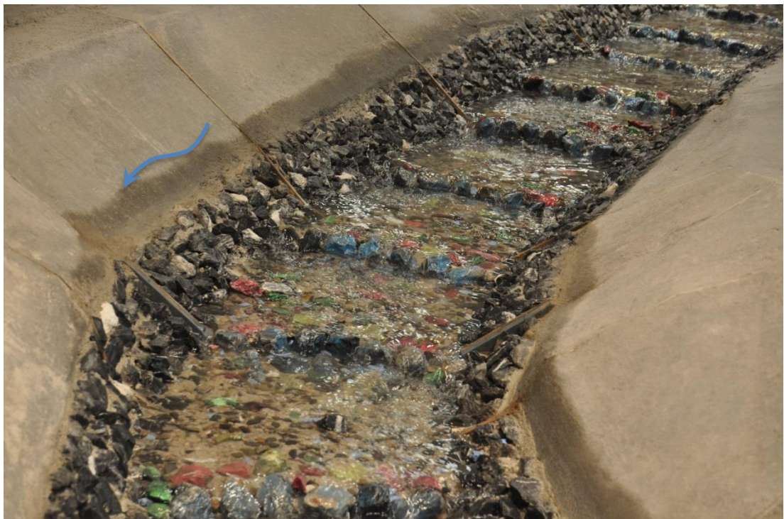
Abbildung 77: Stufen im Bereich der heutigen Sperre nach der HQ_{300} -Überlastfall-Ganglinie bei Niedrigwasser.
