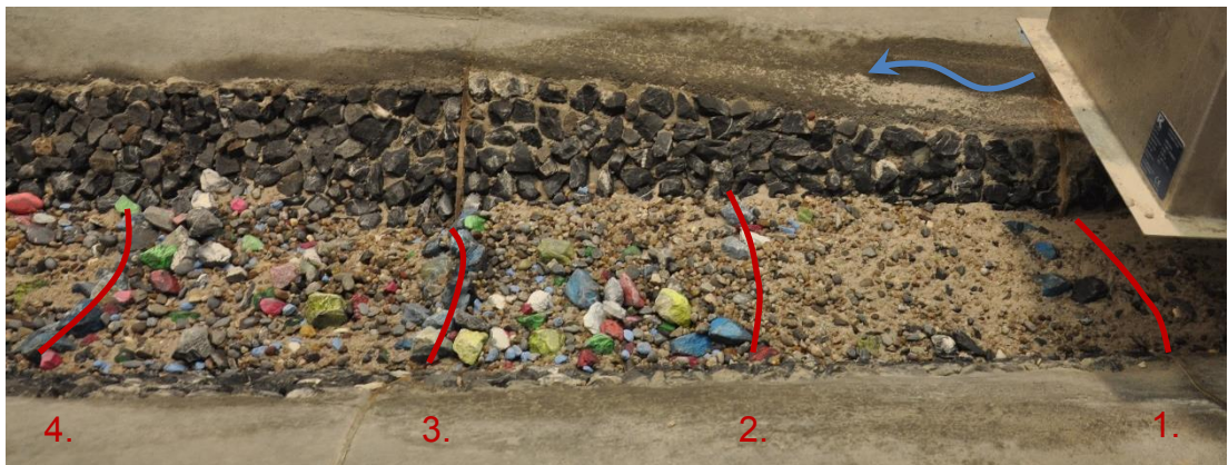
Abbildung 70: Stufen Nr. 1 - 4, nach Kollaps ohne Abfluss.
