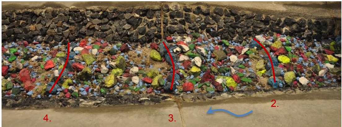
Abbildung 60: Zerörter Kolkschutz bei Stufe Nr. 3 nach 113.4 \text{ m}^3/\text{s} .
