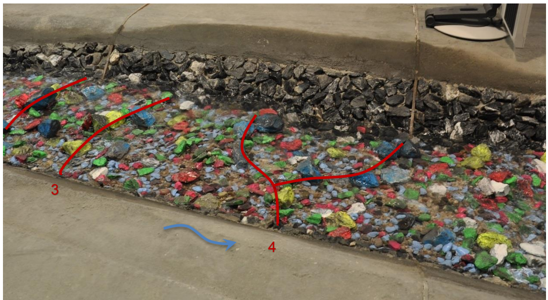
Abbildung 26: Eingezeichnete Stufen zwischen Profil 2.557 und 2.529 bei Niederwasser nach einem Abfluss von 91 m 3 /s.
