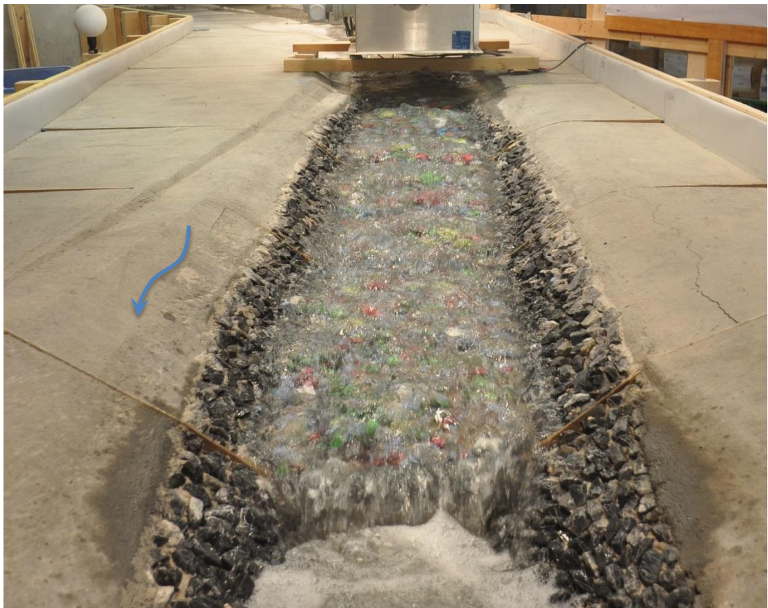
Abbildung 63: Sohle mit eingebauten Stufen beim HQ_5 .
