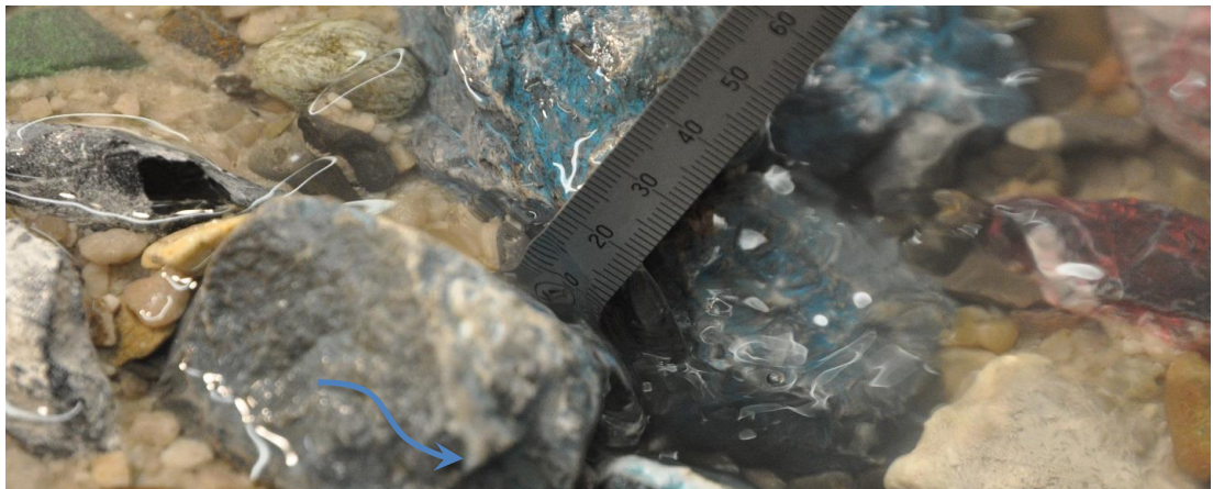
Abbildung 99: Vermessung der Abflusstiefe in der Engstelle bei Stufe 2 bei 1.4 m 3 /s.
