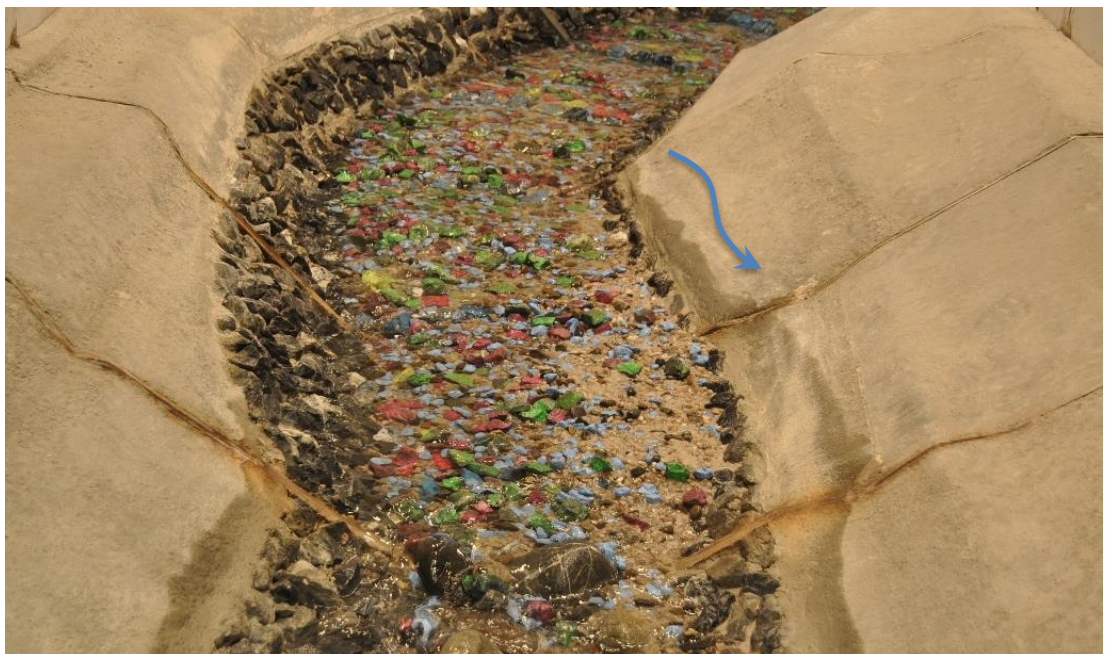
Abbildung 73: Kurvenbereich im Projektperimeter bei Niederwasser nach Belastung mit HQ5.
