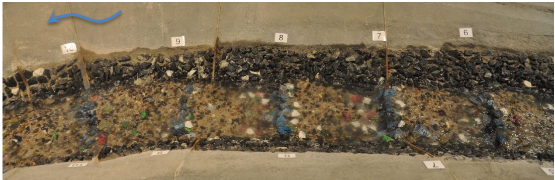
Abbildung 90: Stufen 6 bis 10 nach A2_05.1_HQ100G bei Niederwasser.
