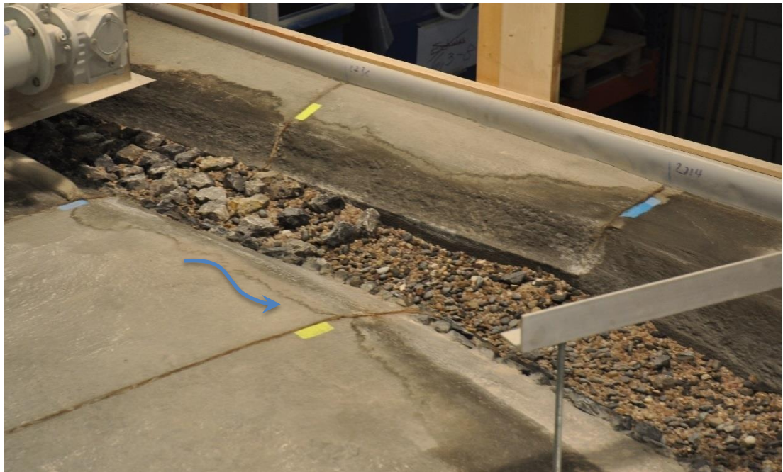
Abbildung 31: Sohle im Zulaufbereich nach Teilversuch A1_02.1_HQ100S, Blöcke zur Befestigung des Einlaufbereichs und abgesenkte Sohle klar sichtbar.
