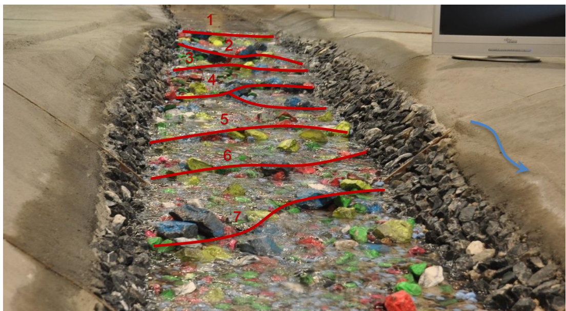
Abbildung 24: Foto mit eingezeichneten Stufen bei Niederwasser nach einem Abfluss von 91 \text{ m}^3/\text{s} .
