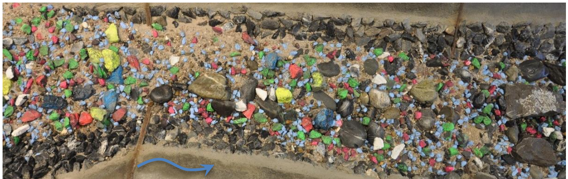
Abbildung 16: Geschiebeausstrag am Ende des Projektperimeters nach HQ 5 bei Versuch A1_02.1.
