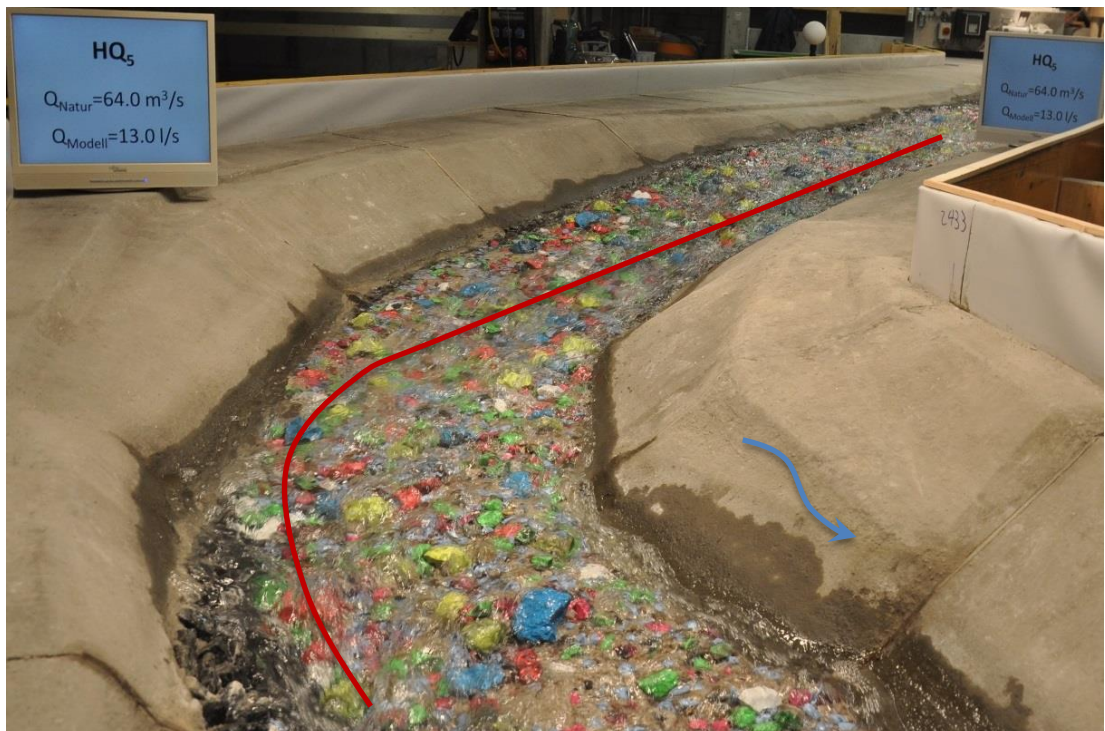
Abbildung 11: Kurvensituation beim HQ_5 mit rot eingezeichneter Strömungskonzentration.
