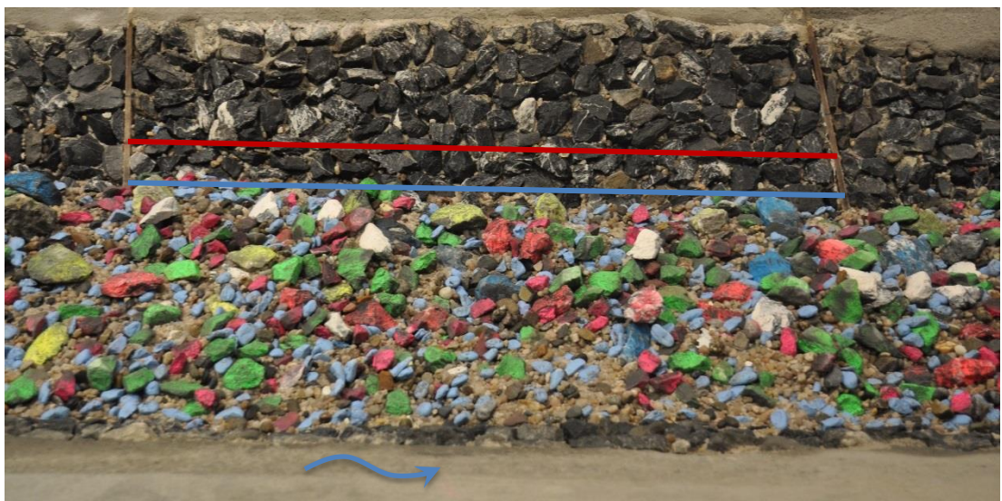
Abbildung 36: Ansicht der linken Böschung mit eingebauter (rot) und projektierte (blau) Sohlenlage nach Versuch A1_03.1_HQ 5 S.
