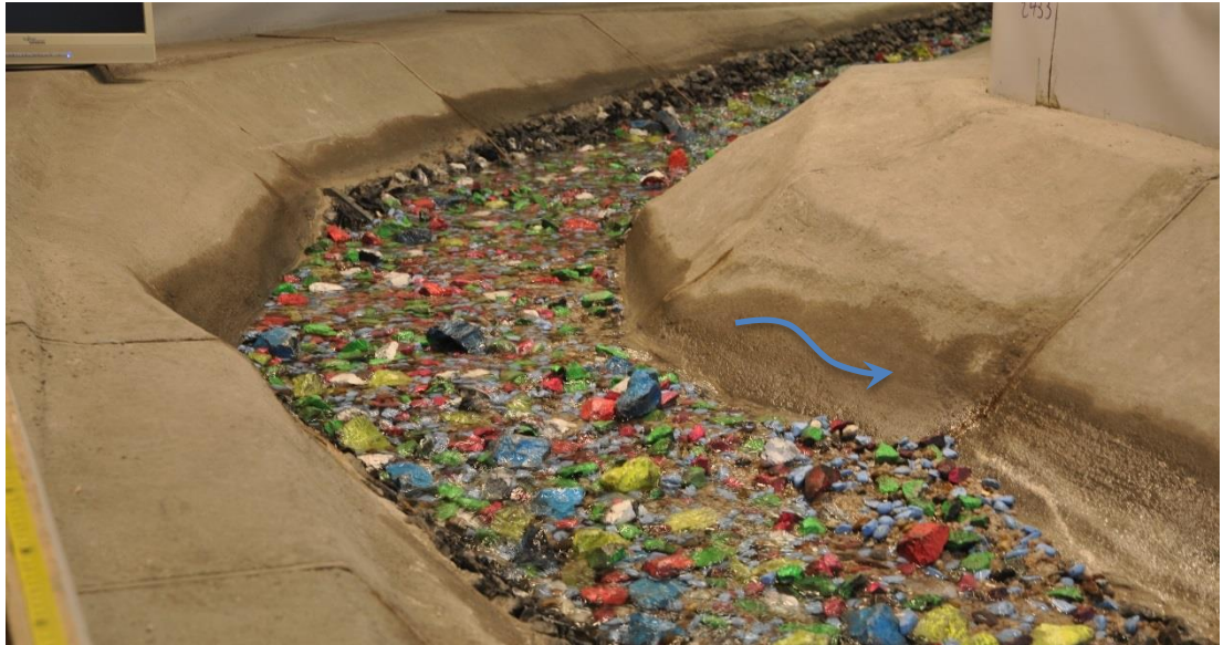
Abbildung 27: Kurvenbereich im Projektperimeter bei Niederwasser nach einem Abfluss von 91 \text{ m}^3/\text{s} .
