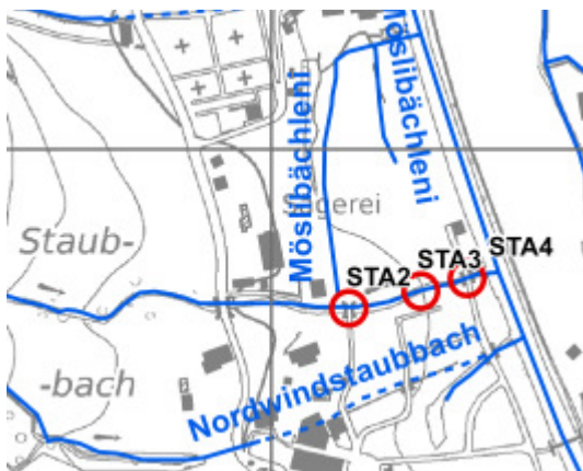
Abbildung 13: Schwachstellen des Staubbaches. Aus [19]
